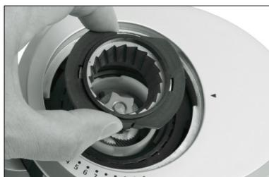
Затем установите корпус жерновов на направляющие перемалывающего блока.
