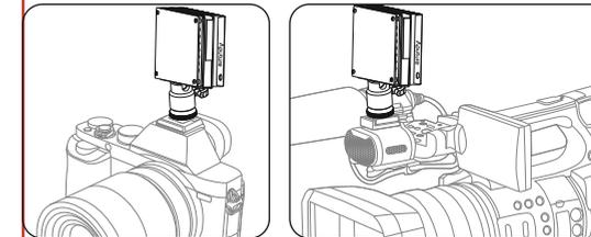
2). Установка осветителя на штатив с помощью винта диаметром 1/4 дюйма.
